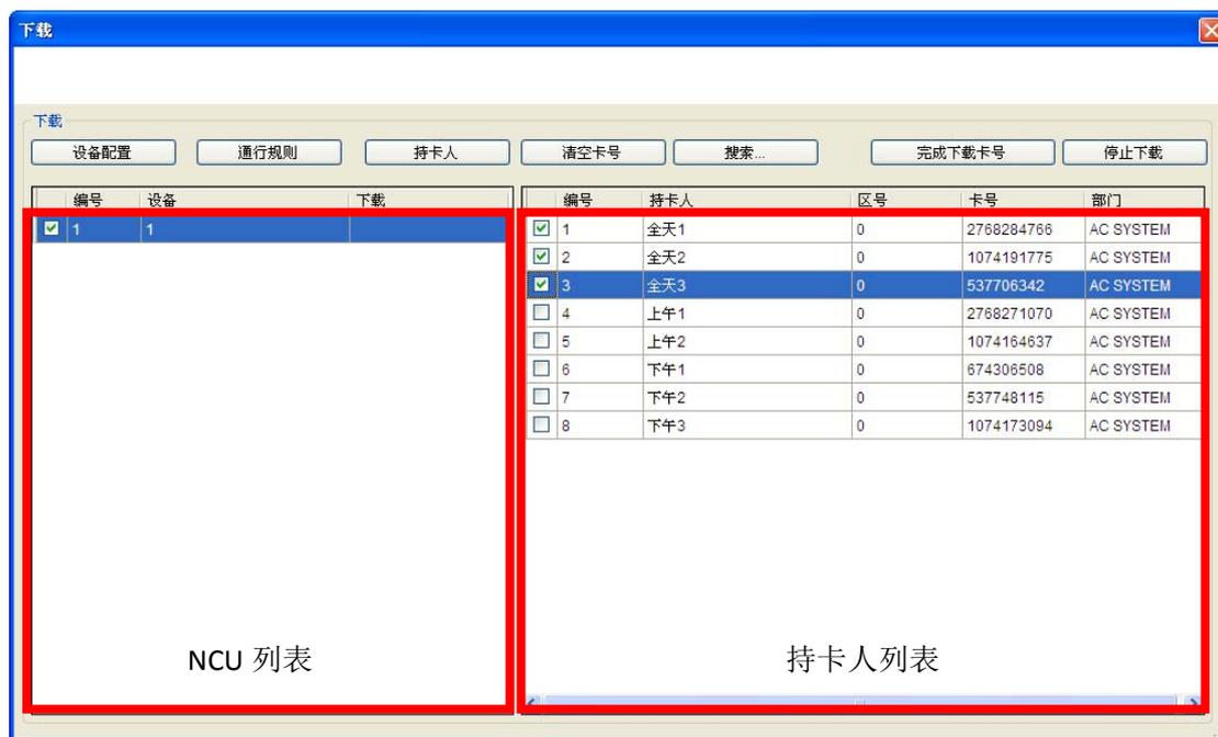
下载功能是用来将全部系统配置和软件设置从服务器计算机下载到 NCU 网络控制器上。
